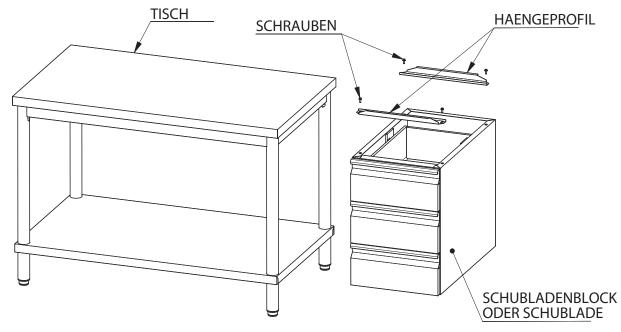
3. Anmerkung - die Arbeitsplatte ist versteckt Schieben Sie den Schubladenblock in der endgültigen Stellung, schließen Sie die Befestigungsschrauben und stecken Sie die Schublade hinein
