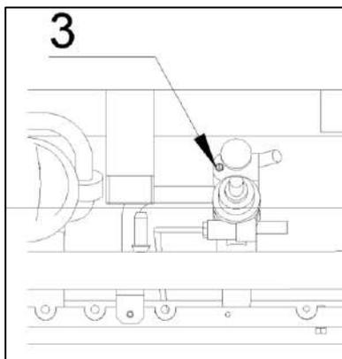
Pour changer le by-pass, il est avant tout nécessaire de retirer les commandes (1) et ensuite le panneau (2). Une fois la zone de travail dégagée, dévisser le by-pass (3) à l'aide d'un tournevis et le remplacer par le by-pass adapté au type de gaz utilisé. Remettre en place le panneau et les commandes.
