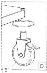
6. Установить упоры над поворотными колесами и прикрепить их к боковым частям, вкручивая поворотные колеса в кронштейны боковых частей (**рис. D**). Предпочтительно, чтобы поворотные колеса с фиксаторами были расположены по диагонали.
