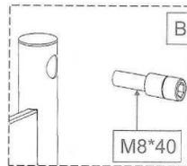
4. Боковые части установить на угловых углублениях верхней горизонтальной поверхности с ограждением, после чего соединить боковые части с верхней горизонтальной поверхностью с ограждением с помощью болтов M8x40 (рис. В).
