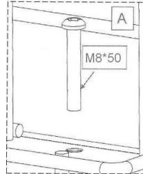
3. Монтаж следует начать от прикрепления верхней горизонтальной поверхности с ограждением к разделительной стенке. Полку с ограждением положить на бок и соединить с разделительной стенкой с помощью 2 болтов M8x50 (рис. А).
