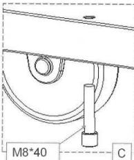
5. Боковые части установить в угловых углублениях нижней полки и сначала соединить нижнюю полку с разделительной стенкой, после чего соединить ее с боковыми частями. Использовать прилагаемые болты M8x40 (рис. С).
