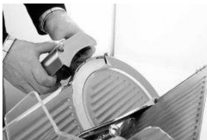
Fig. 3 : Démontage de l'aigiseur
