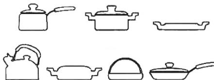
Pour un bon fonctionnement, tous les casseroles et poêles doivent avoir un fond plane et magnétique (un aimant doit y adhérer). Pour obtenir de meilleurs résultats, nous recommandons d'utiliser des casseroles/poêles d'un diamètre entre 12 et 24 cm.
