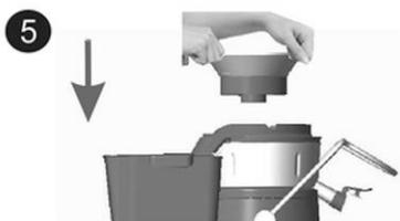
5. Осадить корзину сита в чашу для сока и зафиксировать ее легким поворотом на приводе двигателя.
