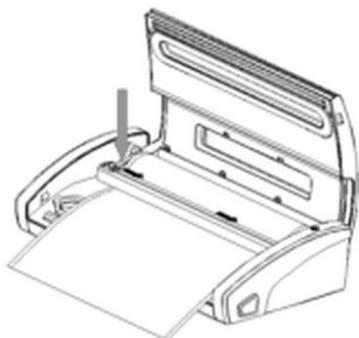
8. Mova a lâmina de um lado para o outro para cortar o saco para embalagem a vácuo com um corte limpo e preciso.
