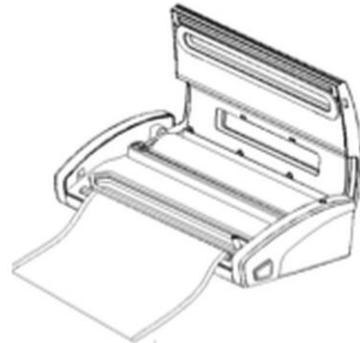
9. A continuación, coloque el extremo abierto de la bolsa de envasado al vacío cortada en la barra de sellado de la máquina, pero no la estire hasta la cámara de vacío.
