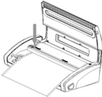
8. Deslice el cuchillo desde un extremo hasta el otro para cortar la bolsa de vacío de manera precisa y limpia.
