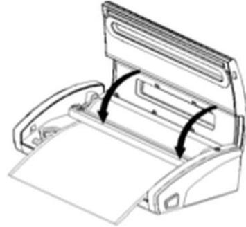
7. Tire del mecanismo de corte hacia abajo y colóquelo sobre el rollo de película
