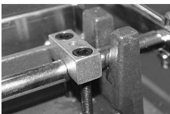
1. Выкрутить винт в задней части защиты ручки для обслуживания.
