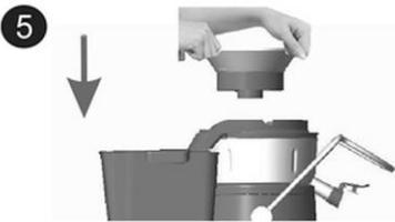
5. Baisser le panier du tamis dans le récipient à jus et le fixer en le tournant légèrement sur le moteur.
