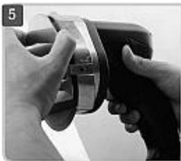
Fixer la protection de la lame avec la bague de protection de la lame, en utilisant les deux vis moletées.
