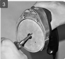
Dévisser la vis de fixation de la lame et retirer avec précaution la lame de l'appareil.
