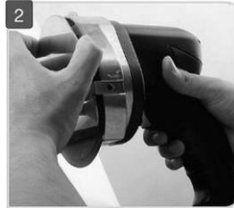
Retirer avec précaution la bague de protection du protège-lame.
