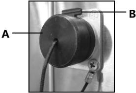
W celu podłączenia sondy temperatury wewnętrznej należy zdjąć zatyczkę **A** (rys. z lewej strony) z miejsca przyłączenia po lewej górnej stronie urządzenia, należy trzymać wciśniętą czerwoną zapadkę **B** i włożyć sondę temperatury wewnętrznej **C** do przewidzianego do tego celu otworu.
