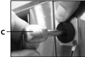
Lassen Sie die rote Einraste-Vorrichtung **B** los. Zum Entfernen erneut die rote Einraste-Vorrichtung **B** drücken, den Kerntemperaturfühler **C** herausziehen und die Einraste-Vorrichtung **B** loslassen.
