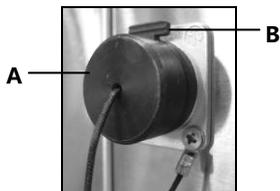
Для подключения температурного щупа следует снять колпачок **A** (рис. слева) с места присоединения с левой верхней стороны прибора, нажимая красную задвижку **B** и вложить температурный щуп **C** в предусмотренное для этой цели отверстие.
