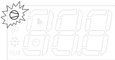
Este indicador LED mostra o estado (ligado ou desligado) COMPRESSOR
