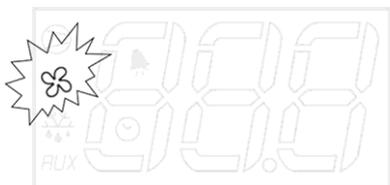
Diese LED zeigt den Zustand (ein oder aus) des LÜFTERS an
