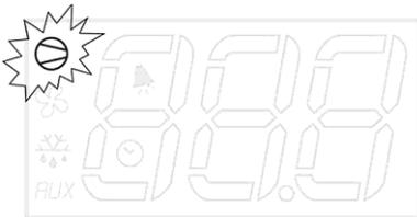
Diese LED zeigt den Zustand (ein oder aus) des VERDICHTERS an
