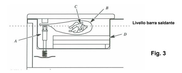
Il prodotto C deve essere allineato alla "mezzaria" con il livello della barra saldante A regolandolo con gli appositi taglieri D (funzione di questi taglieri sono appunto la regolazione di altezza del prodotto da conservare ed il riempimento della camera per una maggiore velocità di esecuzione del vuoto).
