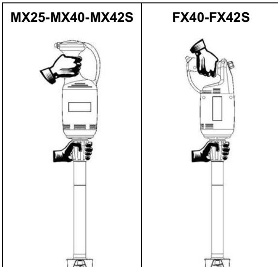
**GEFAHR – ACHTUNG:** Die oberen Gliedmaßen oder andere Körperteile vom Bereich fernhalten, in dem sich das Messer des Rührstabs befinden, wenn dieser an der Motoreinheit angeschlossen ist. Die Rührvorrichtung nur reinigen, wenn sie von der Motoreinheit getrennt ist.
