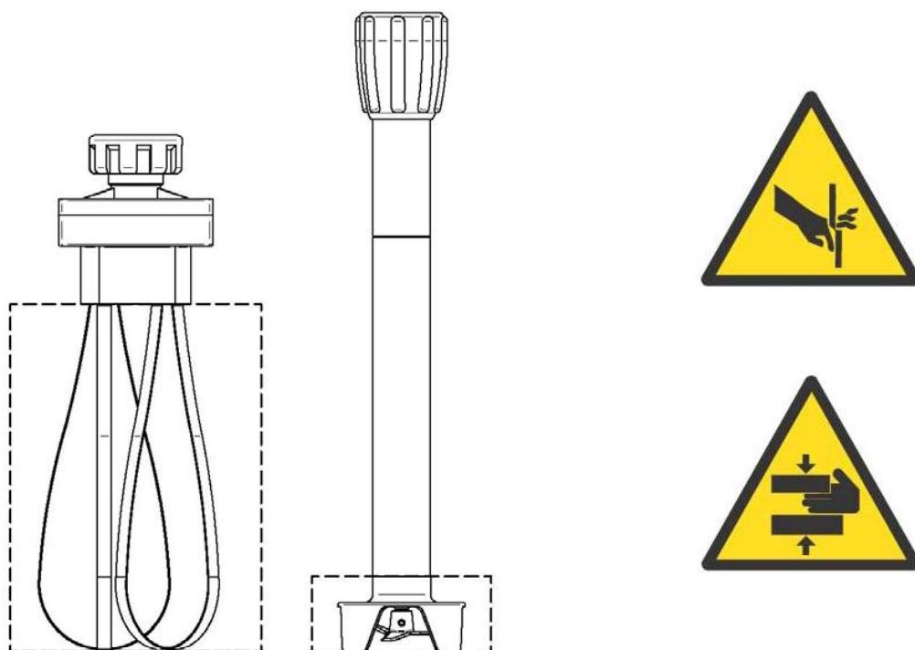
**⚠ GEFAHR – ACHTUNG:** Die oberen Gliedmaßen oder andere Körperteile von den hier gekennzeichneten Gerätebereichen fernhalten, wenn diese an der Motoreinheit befestigt sind. Die Rührvorrichtungen nur reinigen, wenn sie von der Motoreinheit getrennt sind.
