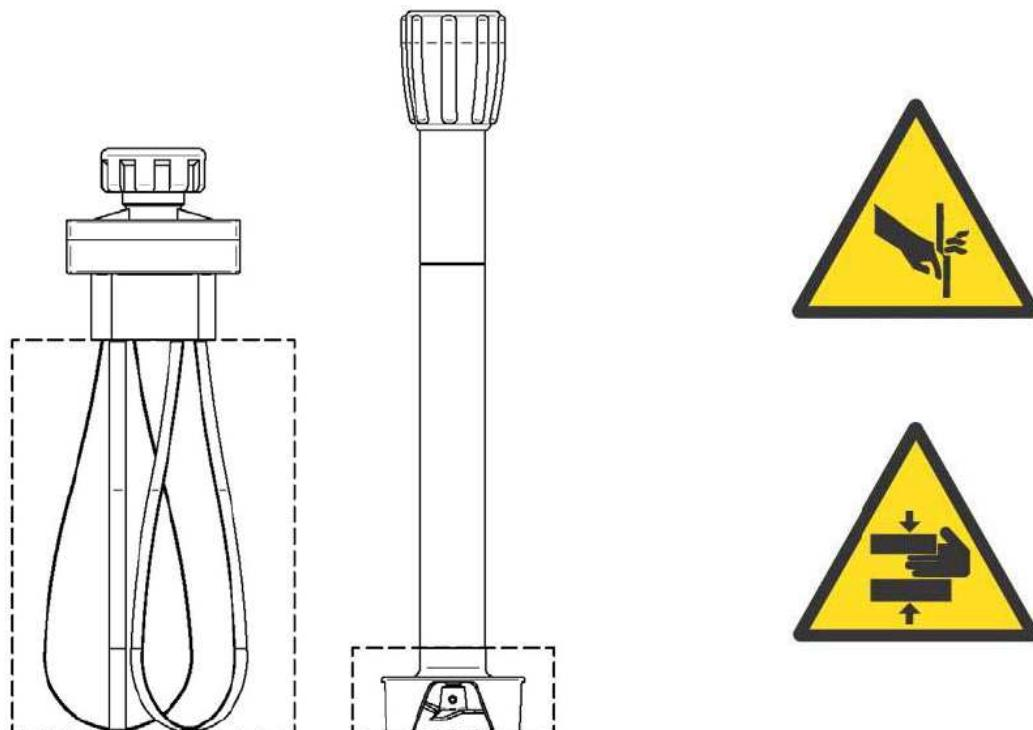
**A** **GEVAAR-OPGELET.** Houd armen en andere lichaamsdelen ver verwijderd van de hier aangegeven onderdelen van het apparaat, aangezien ze zijn bevestigd aan de motor.
