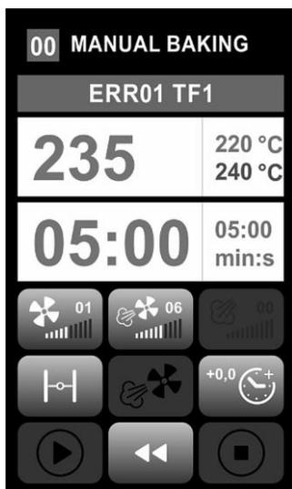
Рис. 43: Ручной режим с отображением ошибок
