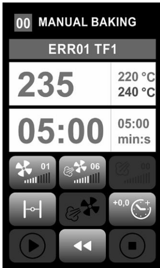
Abb. 43: Manueller Modus mit Fehleranzeige
