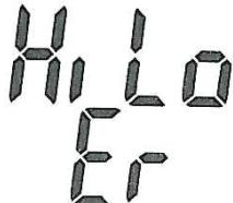
„**Hi**“ lub „**Lo**“ jest wyświetlane, jeśli temperatura pomiaru znajduje się poza zakresem pomiarowym urządzenia. „**Hi**“, jeśli wykracza poza +428°F (+220°C) i „**Lo**“ jeśli spada poniżej -27°F (-33 °C) (jedno i drugie w bezdotykowym trybie podczerwieni) (W „trybie dotykowego czujnika igłowego“ na ekranie LCD pojawia się „**Hi**“, gdy temperatura wykracza poza +626°F (+330 °C) lub „**Lo**“, gdy temperatura spada poniżej 67°F (-55°C).
