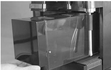
1. Ziehen Sie den Wassertank vom Gerät ab.
