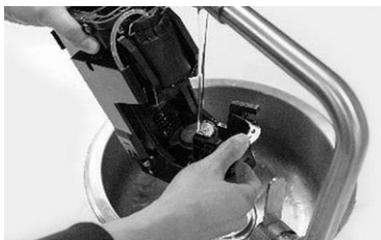
6. Reinigen Sie die Brüheinheit unter fließendem Wasser.
