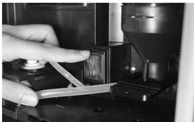
1. Heben Sie das vordere Bedienfeld an und drücken Sie den Netzschalter.
