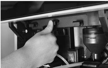
7. Drücken Sie den Verriegelungschieber bis zum Anschlag ein.
