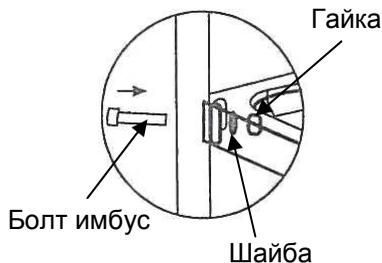
3. Перевернуть тележку для сервировки вверх дном и прикрутить поворотные колесики к каркасу. Над колесиками прикрепить защиту от ударов.
