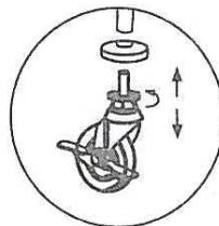
4. Тележку осторожно поставить вертикально и убедиться все ли поворотные колесики прикасаются к полу. Крепко дотянуть болты имбус с помощью ключа с шестигранным наконечником (имбус). Воспользоваться прилагаемым рычажным ключом, чтобы хорошо дотянуть гайки.
