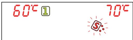
**Avviso mancanza detergente (optional).** Quando sul display lampeggia la spia F10 significa che è necessario sostituire la tanica del detergente (solo se presente l'optional "Sensore mancanza prodotto").
