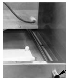
Afvoergoot voor condenswater
