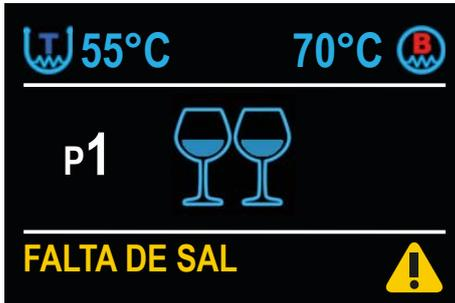
Para agregar sal, abra la puerta de la máquina y desenrosque el tapón del contenedor de sal dentro del tanque. Use sal específica para la regeneración con grano grueso (1-4 mm), prestando especial atención para no dispersarla en el fondo del tanque. Una fuerte concentración de sal puede afectar negativamente el funcionamiento correcto y la vida útil de la máquina y generar óxido y corrosión del acero. Una vez lleno, enroscar el tapón correctamente.
