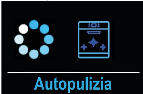
Premere il tasto **Start F**; parte un ciclo di autopulizia automatico di circa un minuto, al termine del quale la macchina rimane in **STAND-BY**. Il display visualizza il messaggio **AUTOPULIZIA TERMINATA**.
