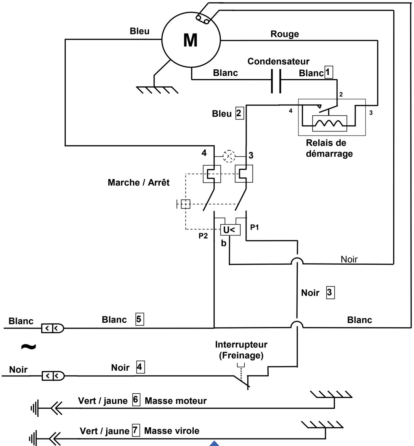
Elektrisch schema 220-240V 50/60Hz
