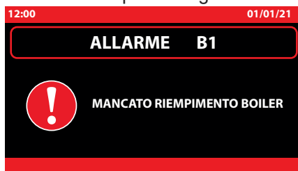
Esempio finestra di allarme.
