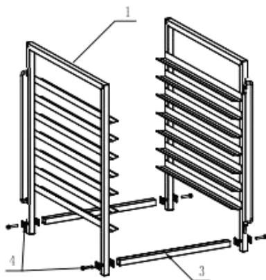
2. Primero monte ambas barras (3) en uno de los 2 elementos laterales montados de fábrica (1) del carro de recogida. Cada vez coloque una arandela cuadrada (4) entre la barra transversal (3) y la parte lateral (1), así como entre la parte lateral (1) y el tornillo (4), y luego, atornille las piezas con la llave Allen.
