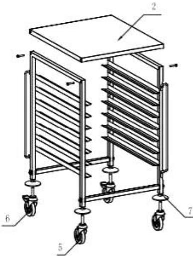
4. Instale la bandeja superior ajustable (2) en las partes laterales (1) con los tornillos (4) incluidos en la entrega.
