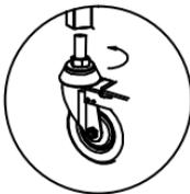
6. Coloque el carro de recogida sobre las ruedas giratorias y compruebe su estabilidad.
