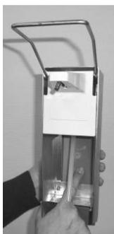
2. Détacher le support mural du boîtier du distributeur en le maintenant appuyé et en le faisant glisser vers le bas.
