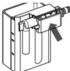
3. Потянуть крышку внутренних элементов системы подачи молока на себя, чтобы снять ее.
