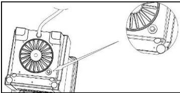
Dieser löst bei Überhitzung des Motors durch zu lange Betriebsdauer oder Überlastung automatisch aus und schaltet das Gerät ab. Lassen Sie das Gerät abkühlen und drücken Sie den **RESET**-Knopf am Boden des Gerätes (Abb. links).
