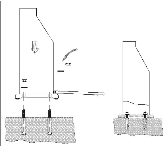
5. Mettez les rondelles plates en place puis le cendrier sur pied précisément sur les vis de fixation des chevilles métalliques. Fixez ensuite le cendrier sur pied avec les écrous et les rondelles élastiques.
