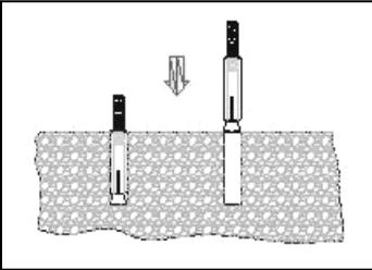
4. Enfoncez les chevilles métalliques avec les vis de fixation dans les trous percés dans le sol, comme indiqué sur l'illustration.
