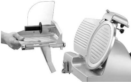
Afloje la manija de ajuste del carro. Si no es posible aflojarla por completo, vuelva a tirar el carro en el sentido de la manija de ajuste del carro hasta que el dispositivo de seguridad se engrane.
