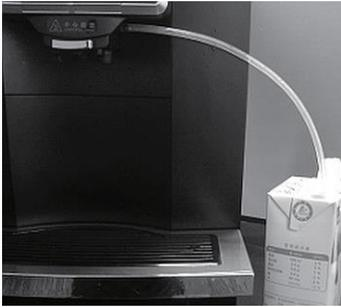
1. Raccorder correctement le tuyau flexible à lait à l'émulsionneur et au réservoir de lait.
