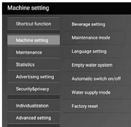
3. Dans le menu des réglages, sélectionner les « Paramètres appareil » et ensuite l'option « Paramètres par défaut »
